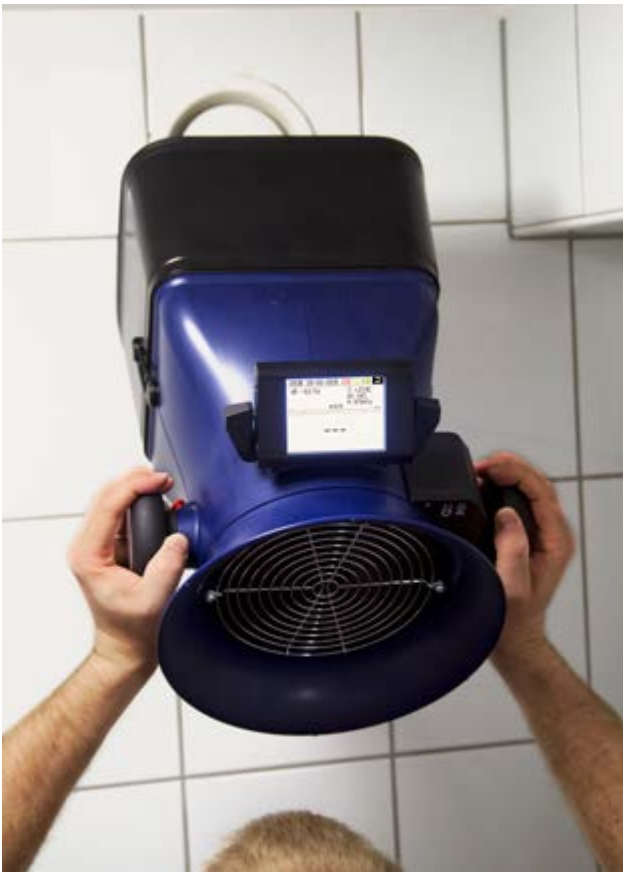
Opzetrechter 23 x 23 cm voor metingen aan kleine inblaas- en afzuigroosters.
