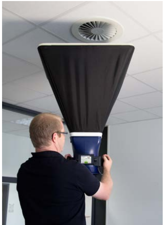
Praktische opzetrechter 60 x 60 cm intern voorzien van gelijkrichter.
