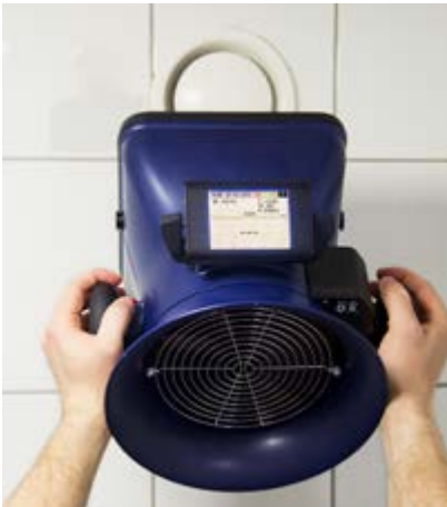
De lichtgewicht Wöhler CFM 600 kan eenvoudig over het ventilatierooster geplaatst worden. Met één druk op de knop wordt de meting gestart.
