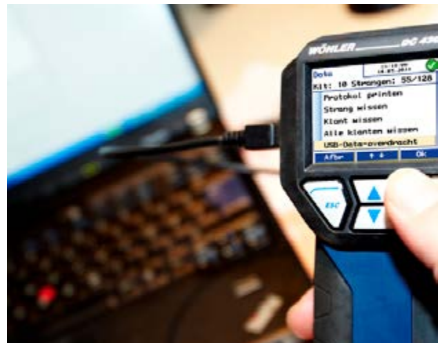
Data-overdracht ter plaatse via de USB naar de laptop.
