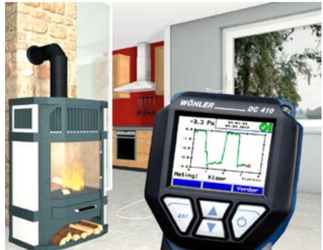
Beoordelen van de ventilatiecapaciteit benodigd bij sfeerhaarden dankzij de 4 Pa-Test.
