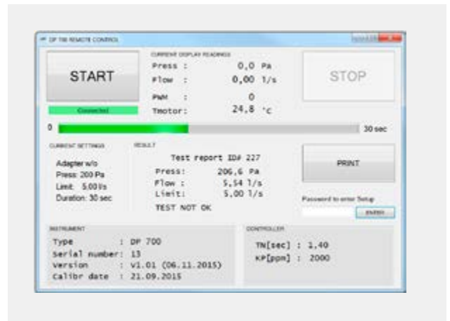
Aansturing via USB vanaf de PC van de Wöhler DP 700 met het optionele Remote Control Programma.
