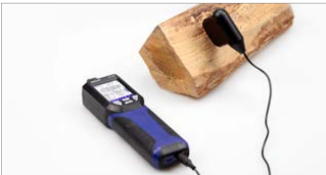
Houtvochtmeting van stukhout met de priksonde houtvocht.
