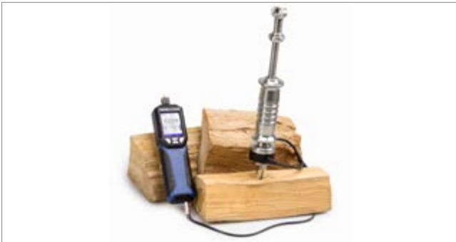
Houtvochtmeting aan stukhout met de Wöhler slaghamerelectrode in geval van opgetast hout.
