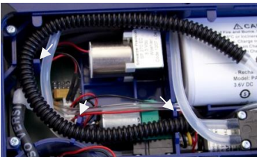
afb. 12: golfslang correct gelegd; geleidingshaken met pijltje gemarkeerd
