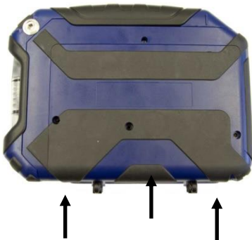
afb. 9: Onderkant van het apparaat – druppunten voor het openen van het deksel
