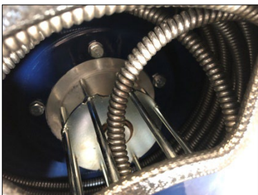
Afb. 23: Spiraal in de trommel verdraaid
