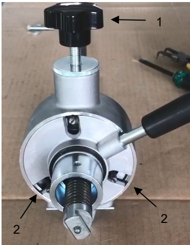
Abb. 11: Vorschubeinheit, Lager mit Pfeil markiert
