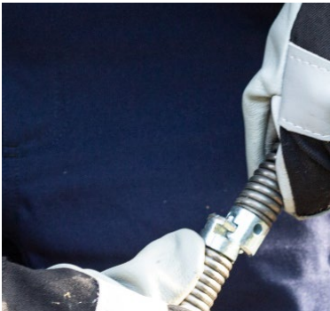
Abb. 4: Reinigungsvorsatz auf Spirale klicken
