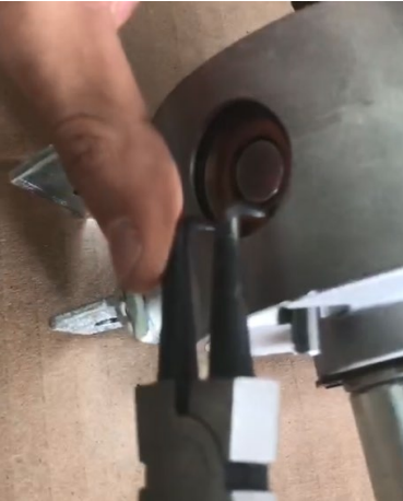
Abb. 12: Entfernen von Spanning und Unterlegscheibe
