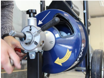
Abb. 10: Vorschubeinheit mit Pfeil markiert
