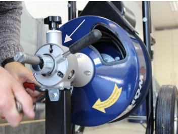
Fig. 34: unité d'avance marquée d'une flèche
