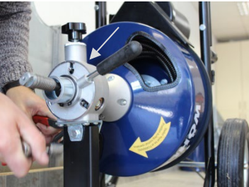
Afb. 24: Toevoereenheid met pijl gemarkeerd
